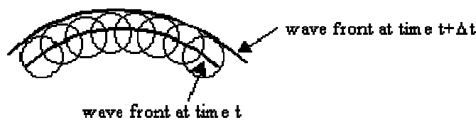
Figura 3.4. Expansión del perímetro del fuego con el principio de Huygens
